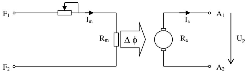
Genom att ändra magnetiseringsströmmen  $I_m$  kan flödet ( $\phi$ ) ändras. Vad sker?
