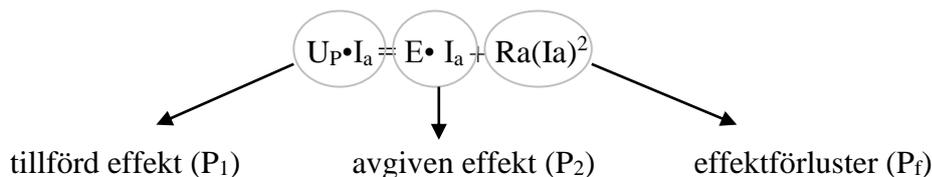
Efter hand som rotorn roterar snabbare och snabbare "förflyttas" effekt från  $P_f$  till  $P_2$ . Det är E som indirekt ger upphov till en avgiven effekt (axeffect).
